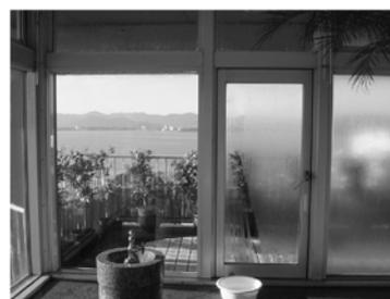
**Figura 8: Comparação entre dois vidros, da esquerda com o tratamento de TiO<sub>2</sub> e o outro vidro normal.**<sup>xv</sup>
