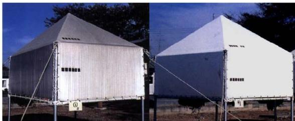
**Figura 6: Duas tendas: à esquerda sem tratamento, à direita com uma película de TiO<sub>2</sub>.**
