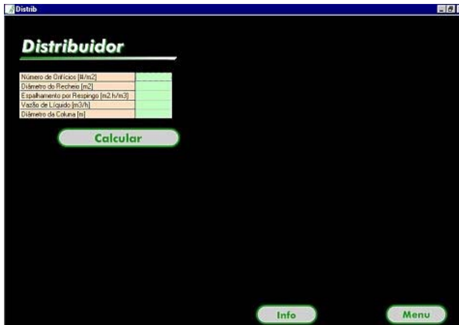
FIGURE. 3 TELA DE ENTRADA DE DADOS PARA SIMULAÇÃO DOS DISTRIBUIDORES DE LÍQUIDOS.
