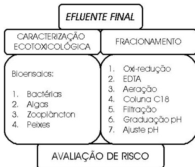
Fig. 1. Monitoramento Ambiental, apresentando as etapas de Caracterização Ecotoxicológica e Fracionamento de Efluentes, objetivando a realização de uma Avaliação de Risco.
