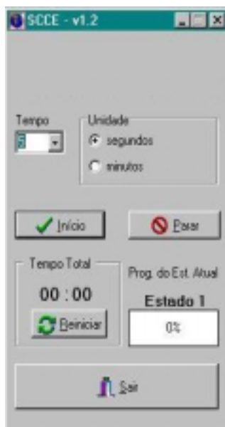
Figura 2: Interface do software de comando do circuito temporizado de inversão polar
