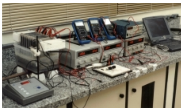
Figura – 3: Foto da Cuba Eletrolítica em funcionamento, a saber: as sondas de temperatura, pH e Condutividade, o circuito reversor temporizado de polaridade, as fontes de alimentação, os multímetros e o microcomputador controlador.
